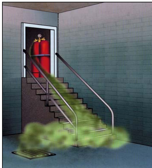
Bild 2.3 Utbredningsmönster för gaser som övergått i flytande form (exempel) 4
