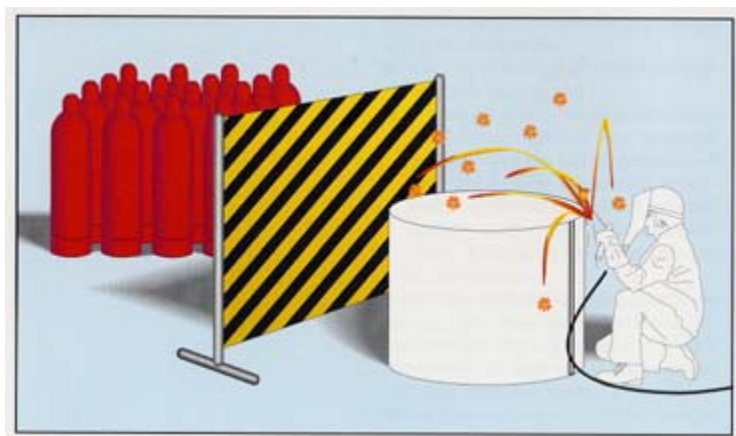
Bild 4.2 Exempel på avskärmning vid arbete där gnistor bildas 4
