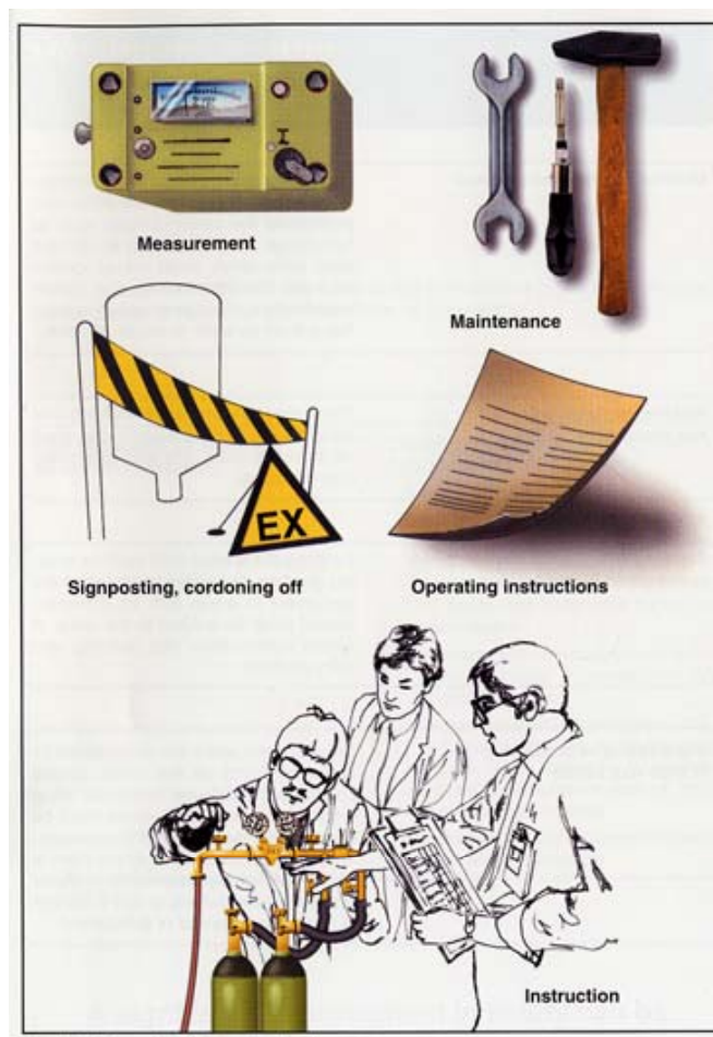
Bild 4.1 Exempel på organisatoriska explosionsskyddsåtgärder 4
