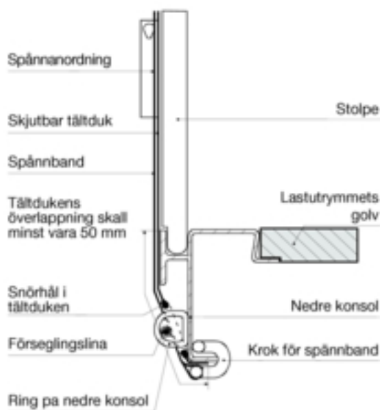
Skiss nr 9.3 TÄLTDUKENS ÖVERLAPPNING - NEDRE DEL
