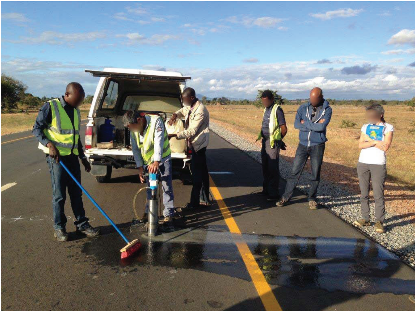
Okvir 3 – Revizorji preučujejo točnost meritev debeline cest za plačilo v zvezi s cestnim projektom v Zambiji
