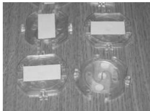
Tento prípad sa zaoberá zásuvkovými chráničmi. Sú to zariadenia, ktoré používateľia (rodičia) umiestňujú na výstupy elektrických zásuviek, aby zabránili kontaktu malých detí so súčasťami pod napäťom, ku ktorému môže dojst' vysnutím dlhého kovového predmetu do niektoréj z dierok na zásuvke, čo by mohlo spôsobiť (smrteľný) elektrický šok.
