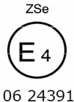
O cinto portador da marca de homologação acima faz parte de um sistema de retenção («Z»), é um cinto de tipo especial («S») e está equipado com um absorvedor de energia («e»). Foi homologado nos Países Baixos (E4) com o número 0624391 e, à data da concessão da homologação, o regulamento já incluía a série 06 de alterações.
