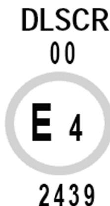
A marcação de homologação acima identifica um sistema de iluminação por repartição utilizando uma fonte luminosa de descarga num gás e que cumpre o disposto no presente regulamento em relação quer ao feixe de cruzamento, quer ao feixe de estrada, destinando-se a ambos os regimes de circulação.
