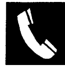
Telefone para luta contra incêndios
