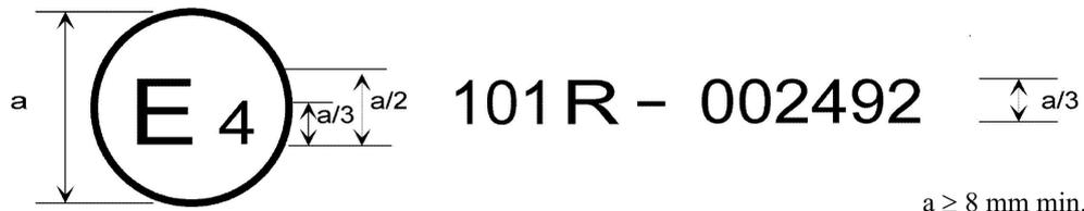
$a \geq 8 \text{ mm min.}$
