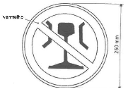
Esta marcação destina-se a vagões que, devido à sua configuração, não podem passar por freios de via ou outros dispositivos de triagem ou frenagem em modo de serviço.
