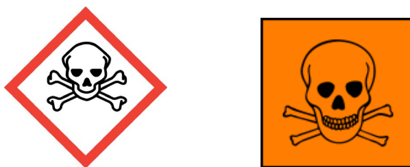
Rys. 5: Nowy piktogram dotyczący toksyczności ostrej określony w CLP i jego wcześniejszy odpowiednik, – niski poziom zrozumienia przez ogół społeczeństwa (33 %).
