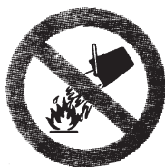
Verboden met water te blussen
