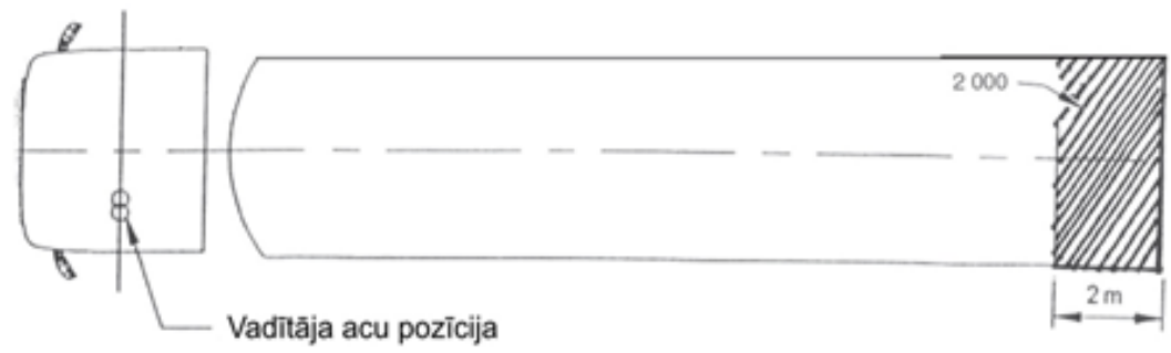
3.3.6.attēls. Atpakaļskata redzamības zona VI klases atpakaļskata spogulī
