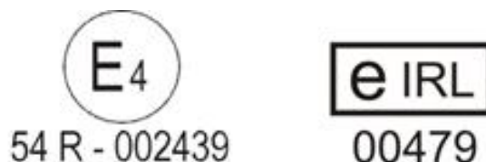
5.2.3.1.attēls. Transportlīdzekļa riepas apstiprinājuma marķējuma piemērs
