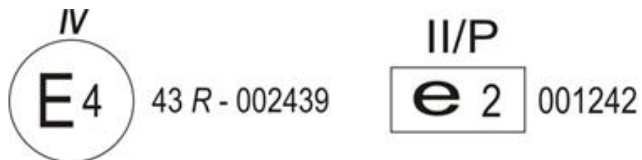
3.2.1.attēls. Transportlīdzekļa stikla apstiprinājuma marķējuma piemēri
