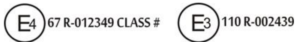
6.1.3.1.attēls. Gāzes barošanas iekārtas sastāvdaļas apstiprinājuma marķējuma piemērs
