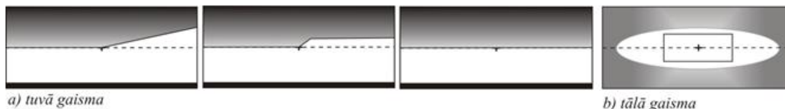
4.1.2.1.attēls. Tuvās un tālās gaismas kūļa shematiskais attēls
