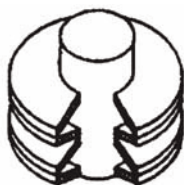
Molla a dischi sovrapposti (spaccato)
