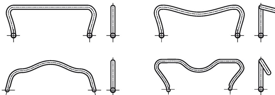
Le barre di torsione sono generalmente barre d'acciaio a sezione circolare o quadrata o fasci di più barre a sezione rettangolare.
