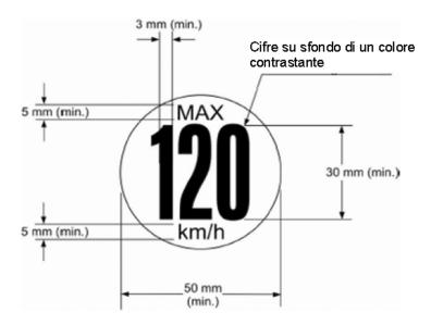
Nel caso di veicoli destinati ad essere venduti in paesi dove si usano le unità di misura del sistema imperiale, sul lato esterno della ruota in posizione visibile è apposto in modo permanente un simbolo supplementare, identico a quello sopradescritto, recante il numero  $^{\circ}$ 75» al posto del numero  $^{\circ}$ 120» e la dicitura  $^{\circ}$ mph» al posto di  $^{\circ}$ km/h».
