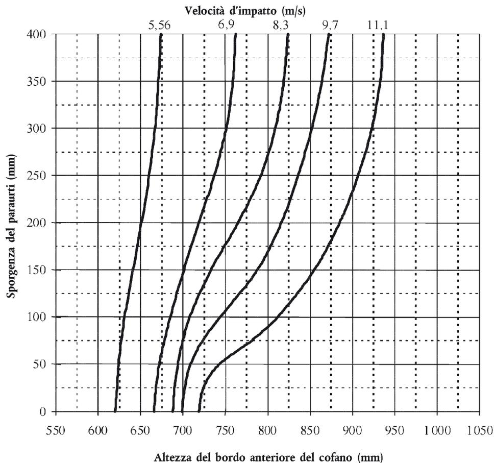
A pagina 42, nell'allegato, parte IV, capitolo IV «Velocità d'impatto del dispositivo di simulazione della coscia contro il bordo anteriore del sistema di protezione frontale», la figura 4 è sostituita dalla seguente:
