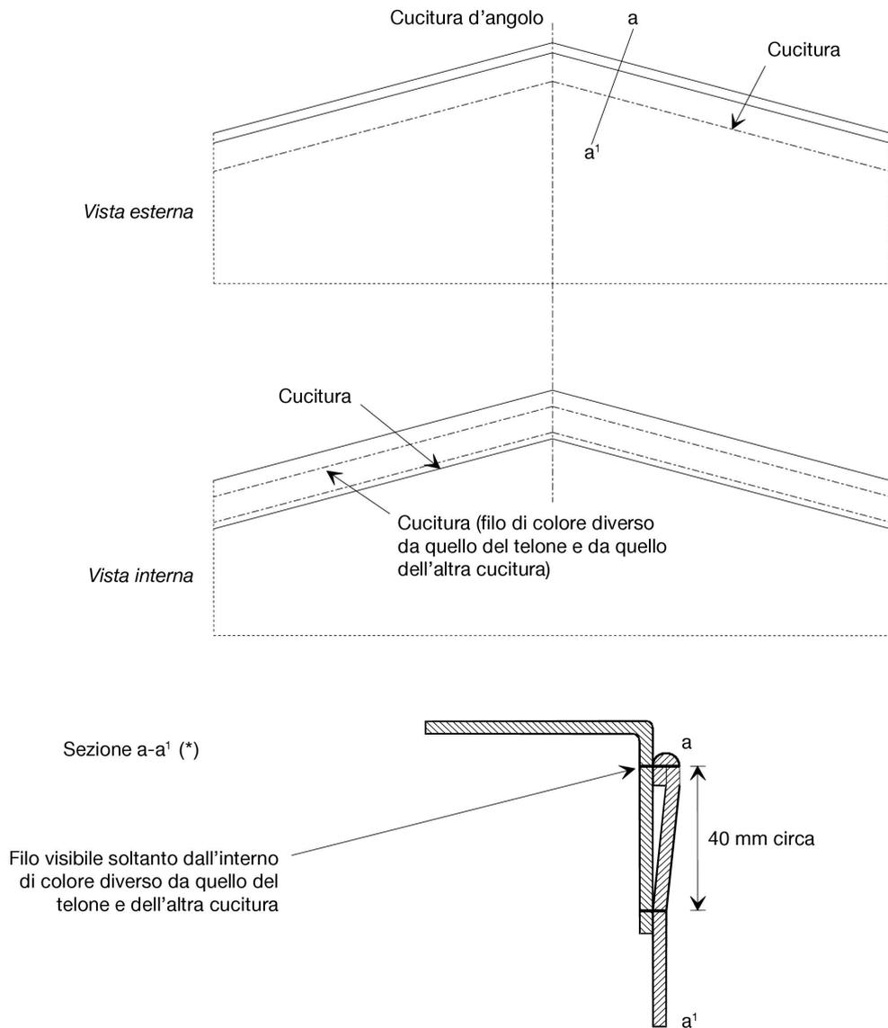
Nota : Sono anche ammesse le cuciture d'angolo eseguite secondo il metodo illustrato nel disegno n. 2 a) dell'allegato 2 della presente Convenzione.
