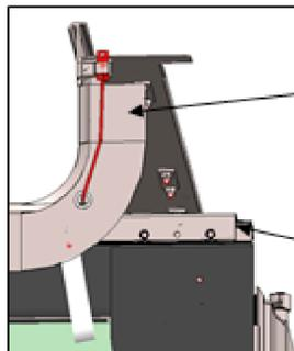
Tenditore sopra la leva. Quando viene abbassata la parte del tetto utilizzando il tenditore, il cavo di acciaio pretensionato è messo sotto tensione
