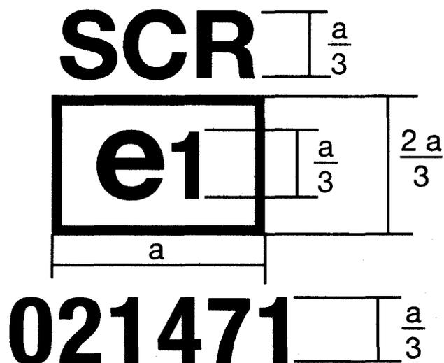
Il dispositivo recante il marchio di omologazione CE qui raffigurato è un proiettore sigillato conforme alle prescrizioni dell'allegato III (numero progressivo 02) riguardo al fascio anabbagliante e al fascio abbagliante e destinato unicamente alla guida a destra, omologato in Germania (e1) con il numero di omologazione di base 1471.
