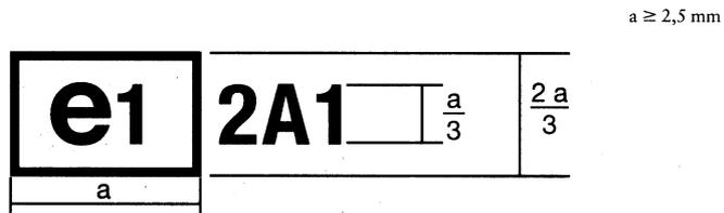
Il marchio di omologazione di cui sopra apposto sulla sorgente luminosa indica che la sorgente luminosa è stata omologata in Germania (e1) con il codice di omologazione 2A1. Il primo carattere indica che la sorgente luminosa è conforme alle prescrizioni dell'allegato VII rispetto alle lampade.
