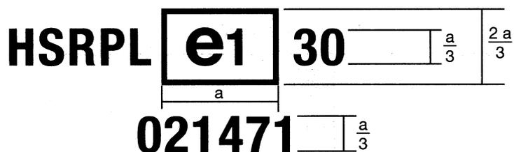
Il dispositivo recante il marchio di omologazione CE qui raffigurato è un proiettore alogeno sigillato con un proiettore alogeno sigillato con un trasparente di materia plastica, conforme alle prescrizioni dell'allegato VI (numero progressivo 02) riguardo al fascio abbagliante e destinato unicamente alla guida a destra, omologato in Germania (e1) con il numero di omologazione di base 1471. Per il significato del numero 30, cfr. esempio 4.
