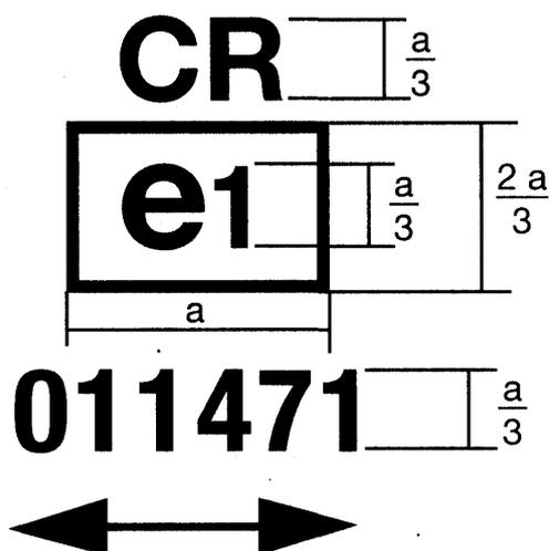
Il dispositivo recante il marchio di omologazione CE qui raffigurato è un proiettore conforme alle prescrizioni dell'allegato II (numero progressivo 01) riguardo al fascio anabbagliante e al fascio abbagliante, destinato a entrambi i sensi di circolazione mediante regolazione dell'unità ottica oppure della luce, omologato in Germania (e1) con il numero di omologazione di base 1471.
