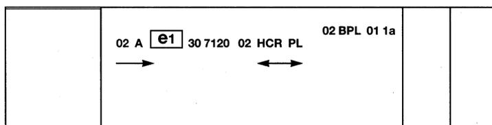
*Nota:* I quattro esempi di marchi di omologazione, modelli A, B, C e D, rappresentano quattro possibili varianti di marcatura di un dispositivo di illuminazione o di segnalazione luminosa, dove due o più luci fanno parte dello stesso insieme di luci raggruppate, combinate o mutuamente incorporate. Il presente marchio di omologazione indica che il dispositivo è stato omologato in Germania (e1) con il numero di omologazione di base 7120 e comprende:
