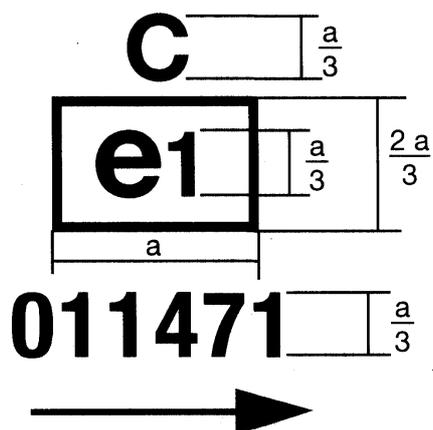
Il dispositivo recante il marchio di omologazione CE qui raffigurato è un proiettore conforme alle prescrizioni dell'allegato II (numero progressivo 01) riguardo al fascio anabbagliante e destinato unicamente alla guida a sinistra, omologato in Germania (e1) con il numero di omologazione di base 1471.
