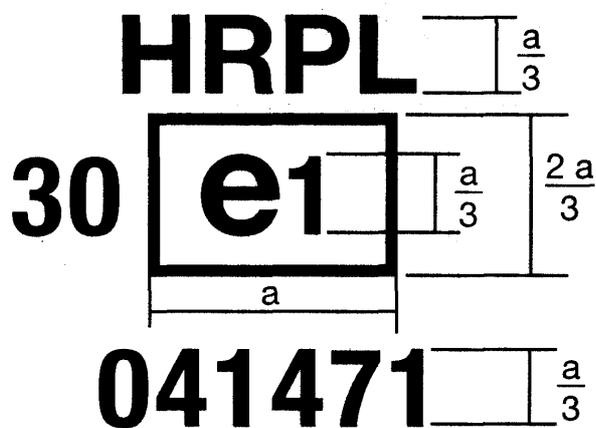
Il dispositivo recante il marchio di omologazione CE qui raffigurato è un proiettore con un trasparente di materia plastica, conforme alle prescrizioni dell'allegato IV (numero progressivo 04) riguardo al fascio abbagliante e destinato unicamente alla guida a destra, omologato in Germania (e1) con il numero di omologazione di base 1471. Il numero 30 indica un'intensità massima del fascio abbagliante compresa tra 86 250 e 101 250 candele.
