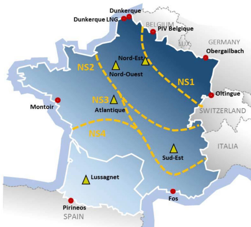
1. ábra: A szállítóhálózatban potenciálisan megfigyelhető főbb működési korlátok abban az esetben, amikor a szolgáltatók Északkelet-Franciaország felől igyekeznek maximalizálni a földgázbetáplálást
