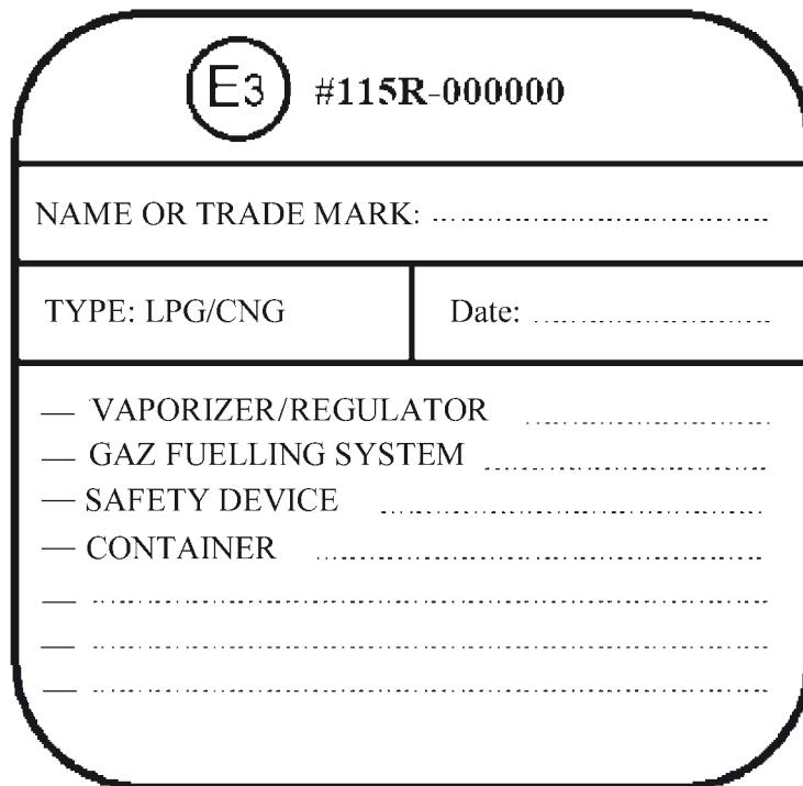
Gornja pločica s homologacijskom oznakom i određenim tehničkim podacima o sustavu za naknadnu ugradnju mora biti trajno pričvršćena na karoseriju vozila.
