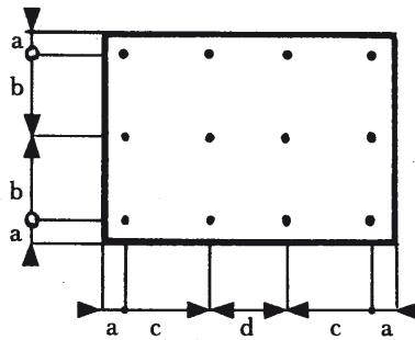
(b) Uređaji za osvjetljivanje široke pločice ( $520 \times 120$  mm)
