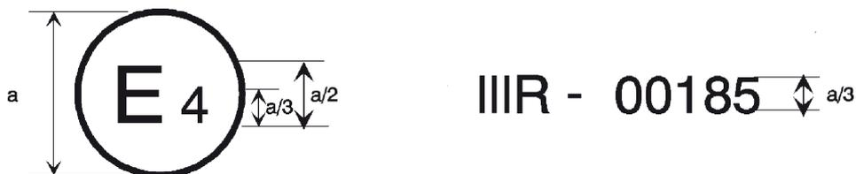
$a \geq 8 \text{ mm min.}$
