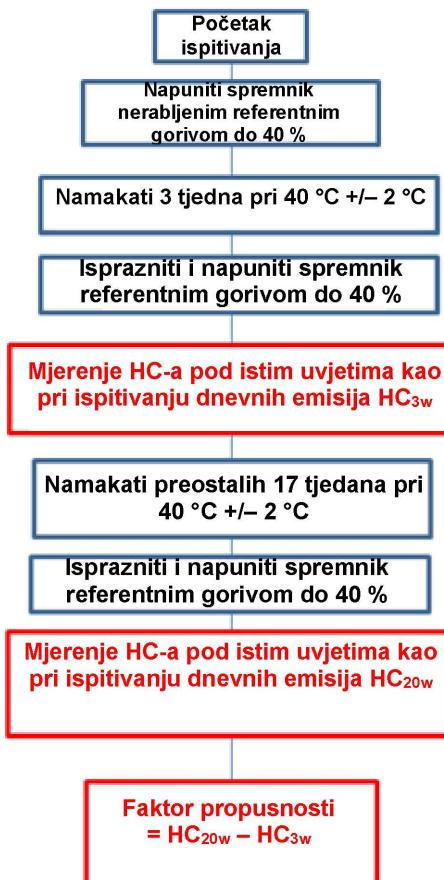
Odabire se sustav za pohranjivanje goriva koji je reprezentativan za porodicu i pričvršćuje se za napravu te se potom 20 tjedana namače u referentnom gorivu E10 na temperaturi  $40\text{ }^{\circ}\text{C} +/ - 2\text{ }^{\circ}\text{C}$ . Položaj sustava za pohranjivanje goriva na napravi mora biti sličan njegovu izvornom položaju u vozilu.
