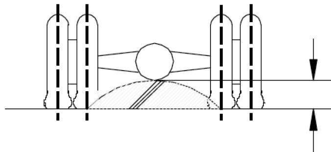
3.2.2. Ovisno o slučaju, mjerjenje zračnosti od tla mora se provesti na svakoj od osovina jedne skupine osovina.
