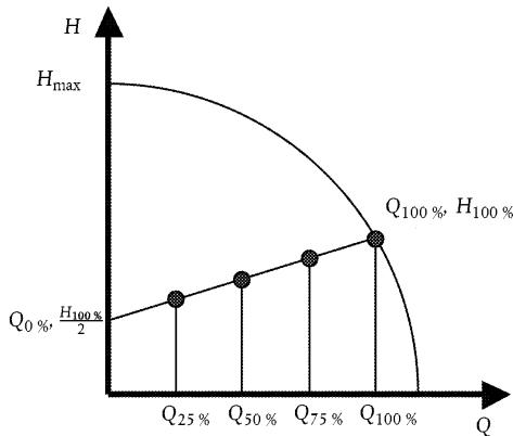
7. Odaberite postavku cirkulacijske sisaljke kojom se osigurava da sisaljka na odabranoj krivulji postigne  $Q \cdot H =$  točka maksimuma. Kod cirkulacijskih sisaljki integriranih u proizvode slijedite referentnu kontrolnu krivulju prilagodavanjem krivulje sustava i brzine cirkulacijske sisaljke.
