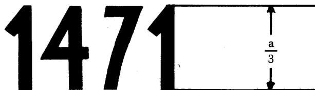
Le dispositif portant la marque d'homologation CEE ci-dessus est un feu de position arrière pour lequel l'homologation CEE a été délivrée au Royaume-Uni (e 11) sous le numéro 1471. L'absence de flèche indique que, vers la droite et vers la gauche, les spécifications photométriques imposées sont satisfaites jusqu'à l'angle de 80° H.
