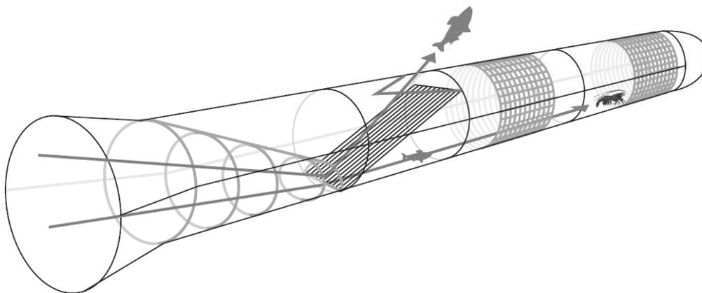
Schéma d'un chalut sélectif par taille et par espèce. Les poissons sont dirigés à l'entrée vers le ventre du chalut et la grille au moyen d'un entonnoir. Les grands poissons sont dirigés hors du chalut par la grille, tandis que les poissons plus petits et les langoustines passent à travers la grille et pénètrent dans le cul du chalut. Le cul de chalut à mailles carrées permet aux petits poissons et aux langoustines n'ayant pas la taille requise de s'échapper.
