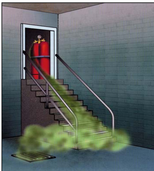
Fig. 2.3: Mode de propagation de gaz liquéfiés (exemple) 4 .
