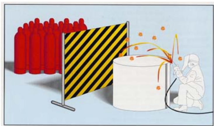
Fig. 4.2: Exemple de moyens de protection lors de travaux provoquant des jets d'étincelles 4
