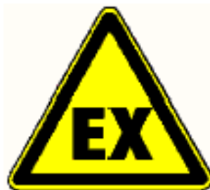
Fig. 4.3: Panneau d'avertissement signalant les emplacements dangereux.
