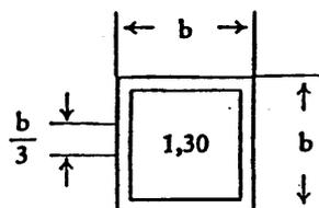
Dimensions minimales de  $b = 5,6 \text{ mm}$
