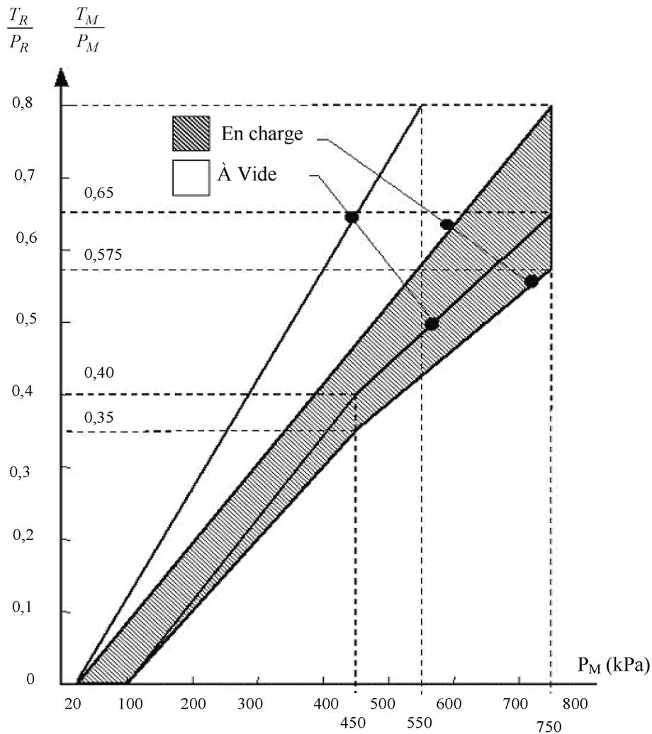
Note: Les rapports prescrits dans le présent diagramme doivent s'appliquer progressivement aux états intermédiaires entre les états à vide et en charge et doivent être obtenus au moyen de systèmes automatiques.
