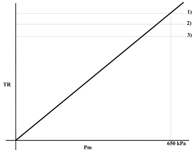
1) =  $TR_{max}$ , lorsque  $p_m = 650$  kPa et pression dans la conduite d'alimentation = 700 kPa
