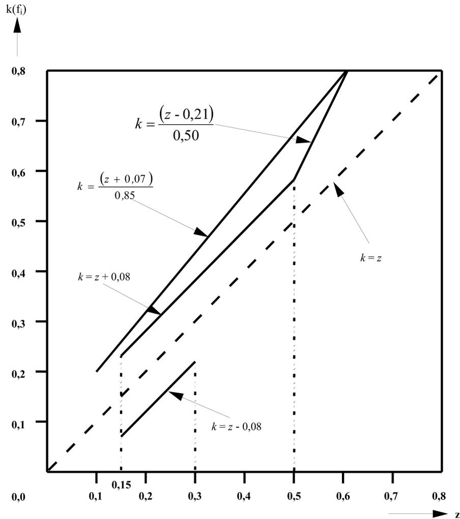
Note: La limite inférieure du couloir  $k = z - 0,08$  n'est pas applicable pour l'utilisation de l'adhérence de l'essieu arrière.
