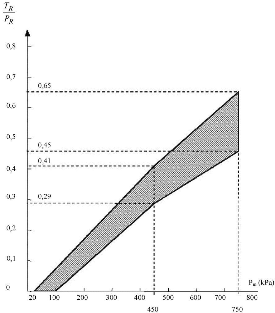
Note: Le rapport entre le taux de freinage  $T_R/P_R$  et la pression dans la conduite de commande pour les états en charge et à vide est déterminé comme suit:
