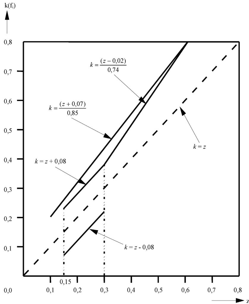
Note: La limite inférieure du couloir  $k = z - 0,08$  n'est pas applicable pour l'utilisation de l'adhérence de l'essieu arrière.
