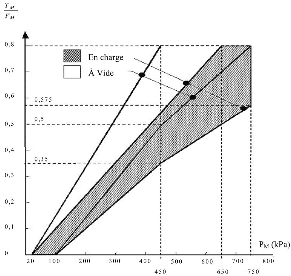
Note: Les rapports prescrits dans le présent diagramme doivent s'appliquer progressivement aux états intermédiaires entre les états à vide et en charge et doivent être obtenus au moyen de systèmes automatiques.
