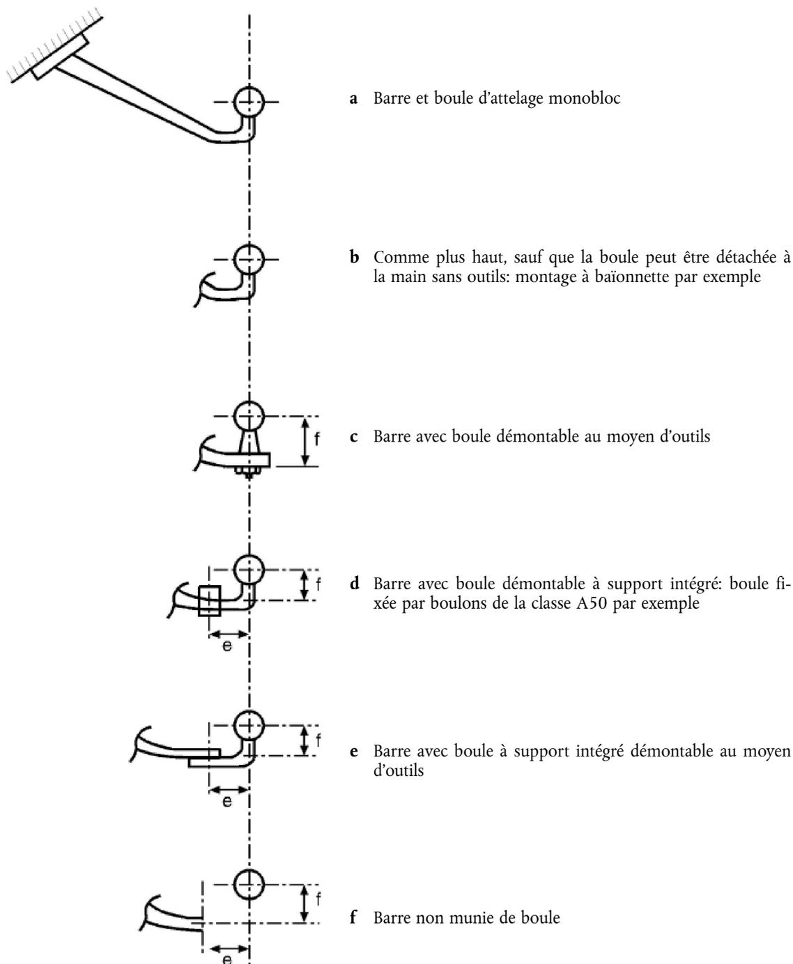
3.1.2. L'essai de base est un essai dynamique de fatigue. L'échantillon se compose de la boule d'attelage, du col et des montages nécessaires pour fixer l'ensemble au véhicule. La boule d'attelage et la barre d'attelage doivent être solidement fixées exactement dans la position dans laquelle elles se trouvent en utilisation, sur l'appareil d'essai, lequel doit être capable de produire une force alternée.
