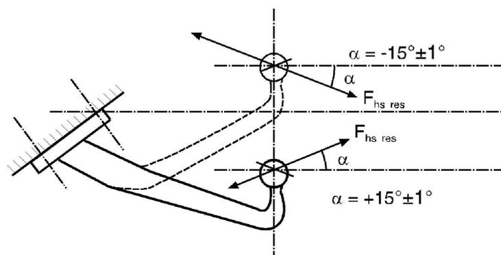
Note: La ligne parallèle à la ligne de référence passe par le centre du point le plus élevé et le plus proche de montage de la barre d'attelage sur le véhicule (voir par. 3.1.5 de l'annexe 6).
