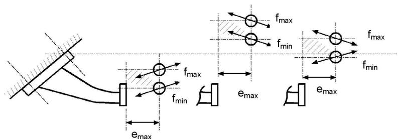
Note: Direction de la force d'essai alternée  $F_{hs, res}$ , en fonction de la position de la ligne de référence horizontale passant par le centre de la boule par rapport à la ligne parallèle à ladite ligne de référence (voir fig. 21).
