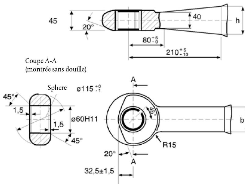
4.2.4. Les anneaux de timon des classes D50-C et D50-D doivent être équipés d'une douille non fendue, ayant les dimensions indiquées à la figure 10.
