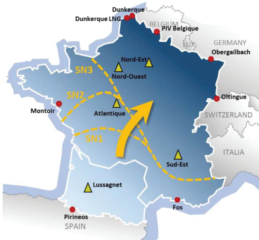
Graphe 10: Principales limites opérationnelles susceptibles d'être observées sur le réseau de transport lorsque les fournisseurs cherchent à maximiser les flux de gaz naturel depuis le sud et l'ouest de la France (21)
