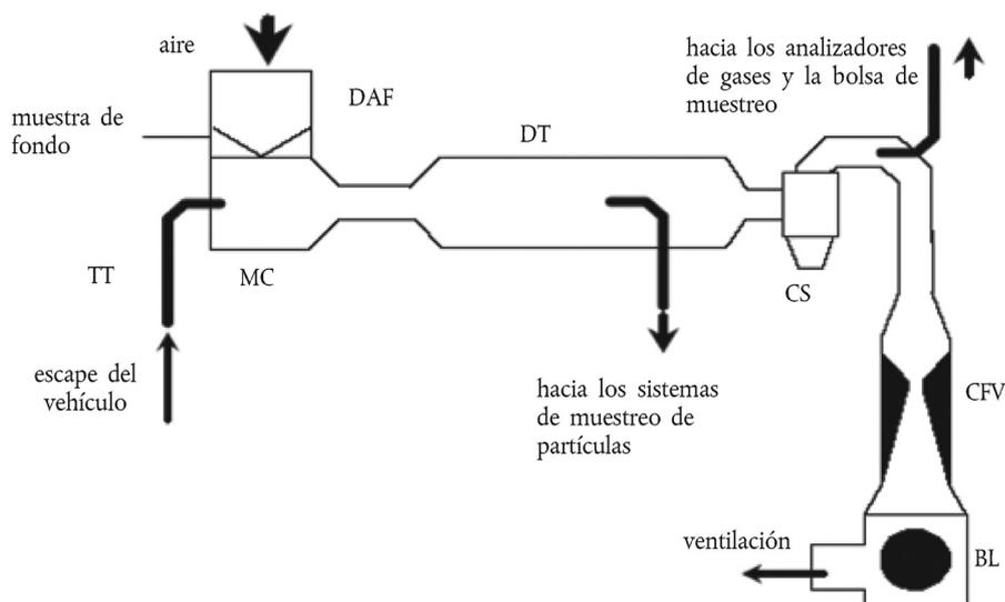
El uso de un venturi de flujo crítico en el sistema de dilución de flujo total se basa en los principios de la mecánica de fluidos para el flujo crítico. El caudal de la mezcla variable de aire de dilución y gases de escape se mantendrá a una velocidad sónica que sea directamente proporcional a la raíz cuadrada de la temperatura de los gases. El flujo se controlará, calculará e integrará constantemente durante todo el ensayo.
