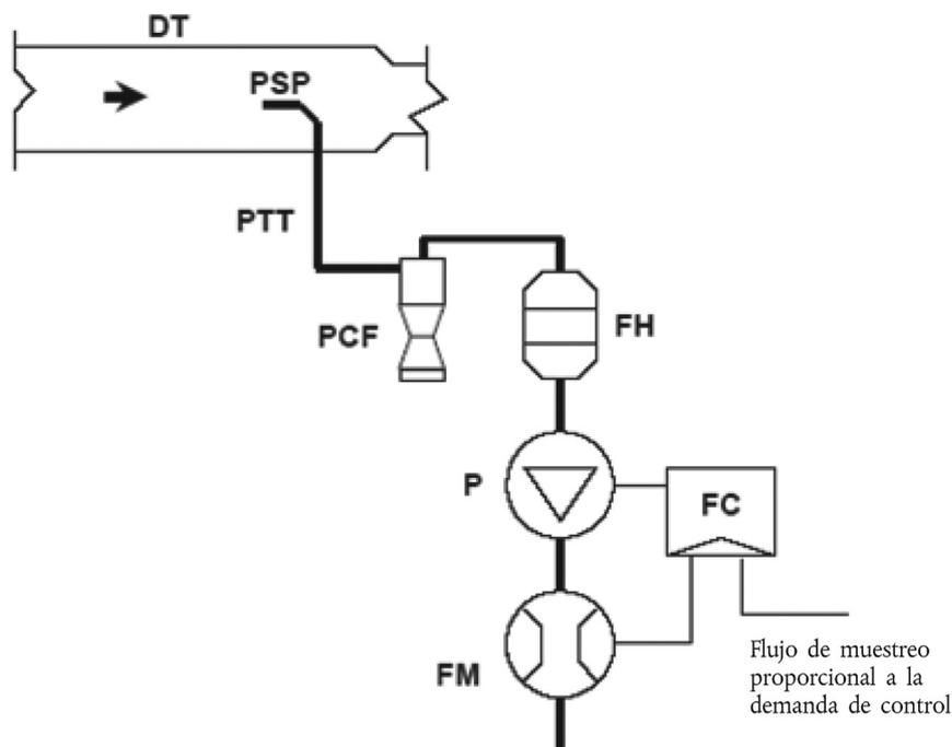
Mediante la bomba (P), se extrae del túnel de dilución (DT) de flujo total, a través de la sonda de muestreo de partículas (PSP) y del tubo de transferencia de partículas (PTT), una muestra del gas de escape diluido. La muestra pasa a través del preclasificador del tamaño de las partículas (PCF) y del o los portafiltros (FH) que contiene(n) el filtro de muestreo de partículas. El caudal de muestreo lo establece el regulador del flujo (FC).
