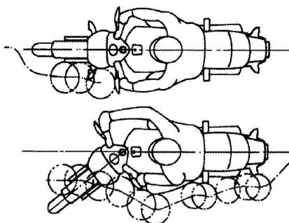
1.2.3.1. La parte delantera del vehículo será el primer punto de contacto, y el dispositivo de ensayo se desplazará lateralmente hacia fuera siguiendo el contorno del vehículo y del conductor, en su caso. El dispositivo de ensayo también podrá desplazarse hacia dentro a una velocidad que no supere la del movimiento hacia atrás (es decir, con un ángulo de 45.º con respecto al plano longitudinal mediano del vehículo).
