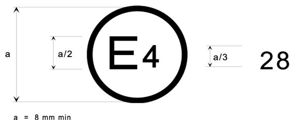
Esta marca de homologación colocada en un vehículo indica que, de conformidad con el Reglamento n° 28, este tipo de vehículo ha sido homologado en los Países Bajos (E4) en lo que respecta a sus señales acústicas.
