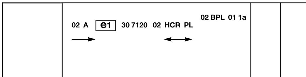
Nota: Los modelos A, B, C y D representan cuatro posibles variantes de marcas de homologación de un dispositivo de alumbrado o señalización luminosa cuando dos o más luces forman parte de la misma unidad de luces agrupadas, combinadas o mutuamente incorporadas. Estas marcas de homologación indican que el dispositivo fue homologado en Alemania (e1) con el número de homologación de base 7120 e incluye:
