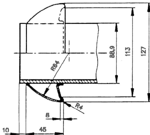
Conexión rápida SFS 4428, parte A de la conexión, tamaño DN80
