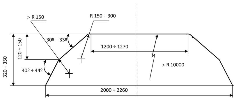
Fig. Patines de contacto: configuración y dimensiones
