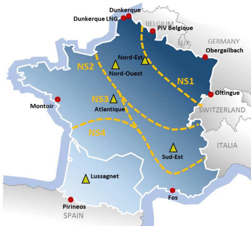
Imagen 1: Principales límites operativos que se pueden observar en la red de transporte cuando los proveedores intentan maximizar las inyecciones de gas natural desde el nordeste de Francia
