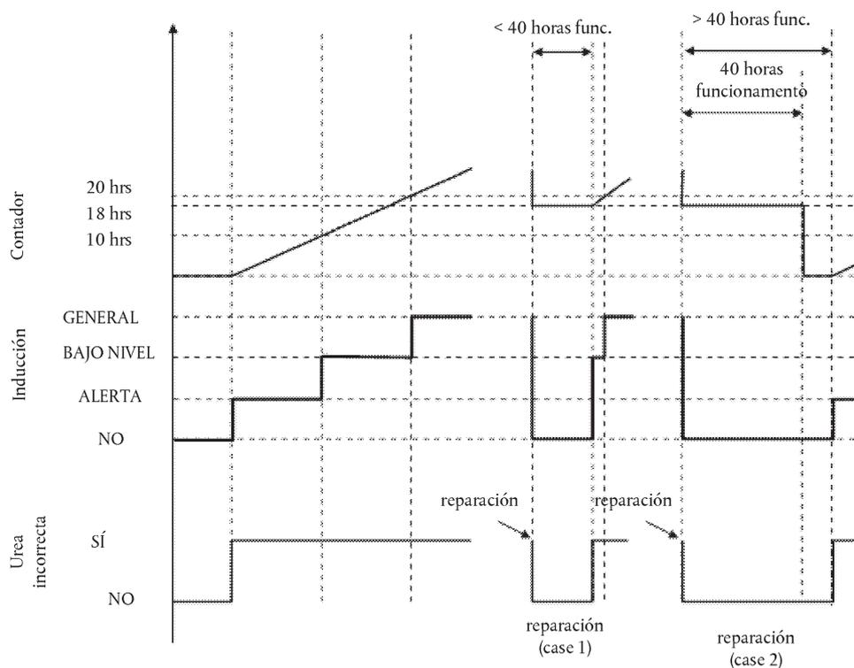
12.4. La figura 4.7 ilustra tres casos de fallo del sistema de dosificación de urea. Esta figura también ilustra el proceso que se aplica en el caso de los fallos de supervisión que figuran en la sección 9.
