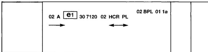
*Nota:* Los modelos A, B, C y D representan cuatro posibles variantes de marcas de homologación de un dispositivo de alumbrado o señalización luminosa cuando dos o más luces forman parte de la misma unidad de luces agrupadas, combinadas o mutuamente incorporadas. Estas marcas de homologación indican que el dispositivo fue homologado en Alemania (e1) con el número de homologación de base 7120 y que incluye:
