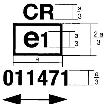
El dispositivo que lleva esta marca de homologación de componente es un proyector que cumple los requisitos del anexo II (número de la última modificación 01) relativos al haz de cruce y al haz de carretera y diseñado para la circulación por la izquierda y por la derecha mediante el ajuste de la unidad óptica de la luz, homologado en Alemania (e1) con el número de homologación de base 1471.
