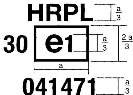
El dispositivo que lleva esta marca de homologación de componente es un proyector que incorpora una lente de plástico, que cumple los requisitos del anexo IV (número de la última modificación 04) relativos al haz de cruce y diseñado únicamente para la circulación por la derecha, homologado en Alemania (e1) con el número de homologación de base 1471. El número 30 indica que el haz de cruce tiene una intensidad luminosa máxima de entre 86 250 y 101 250 candelas.
