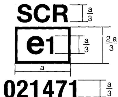
El dispositivo que lleva esta marca de homologación de componente es un proyector sellado que cumple los requisitos del anexo III (número de la última modificación 02) relativos al haz de cruce y al haz de carretera y diseñado únicamente para la circulación por la derecha, homologado en Alemania (e1) con el número de homologación de base 1471.
