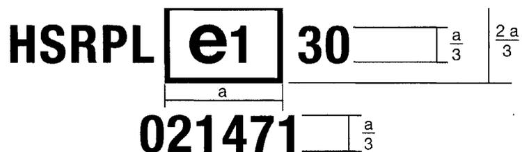
El dispositivo que lleva esta marca de homologación de componente es un proyector halógeno sellado que incorpora una lente de plástico, que cumple los requisitos del anexo VI (número de la última modificación 02) relativas al haz de carretera y diseñado únicamente para la circulación por la derecha, homologado en Alemania (e1) con el número de homologación de base 1471. Sobre el significado del número 30, véase el ejemplo 4.
