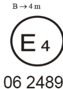
Ein Gurt mit diesem Genehmigungszeichen ist ein Beckengurt („B“) mit einer mehrfach sensitiven („m“) Aufrolleinrichtung des Typs 4, der in den Niederlanden („E 4“) unter der Nummer 062489 genehmigt worden ist; zum Zeitpunkt der Genehmigung enthielt die Regelung bereits die Änderungsserie 06.
