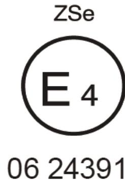
Ein Gurt mit diesem Genehmigungszeichen ist als Teil eines Rückhaltesystems („Z“) ein Spezialgurt („S“) mit Energieaufnahmeeinrichtung („e“). Er wurde in den Niederlanden („E 4“) unter der Nummer 0624391 genehmigt; zum Zeitpunkt der Genehmigung enthielt die Regelung bereits die Änderungsserie 06.
