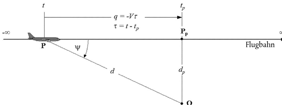
**Abbildung E-1** illustriert die Geometrie der Schallausbreitung zwischen der Flugbahn und dem Standort des Beobachters **O**. Das Luftfahrzeug in **P** fliegt in stiller gleichförmiger Luft mit einer konstanten Geschwindigkeit auf einer geraden, horizontalen Flugbahn. Der Punkt des kleinsten Vorbeiflugabstands vom Beobachter ist **P<sub>p</sub>**. Die Parameter sind
