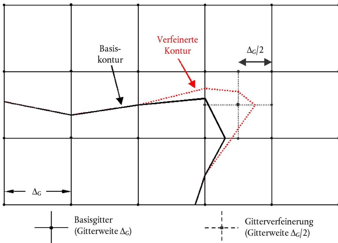
Eine deutliche Verbesserung der Recheneffizienz mit genaueren Ergebnissen wird mit der Verwendung eines unregelmäßigen Gitters zur Verfeinerung der Interpolation in kritischen Zellen erzielt. Das in **Abbildung 2.7.s** abgebildete Verfahren besteht darin, die Maschenweite lokal zu verengen und den Großteil des übrigen Gitters unverändert zu lassen. Dies ist sehr unkompliziert und erfolgt mit den folgenden Schritten:
