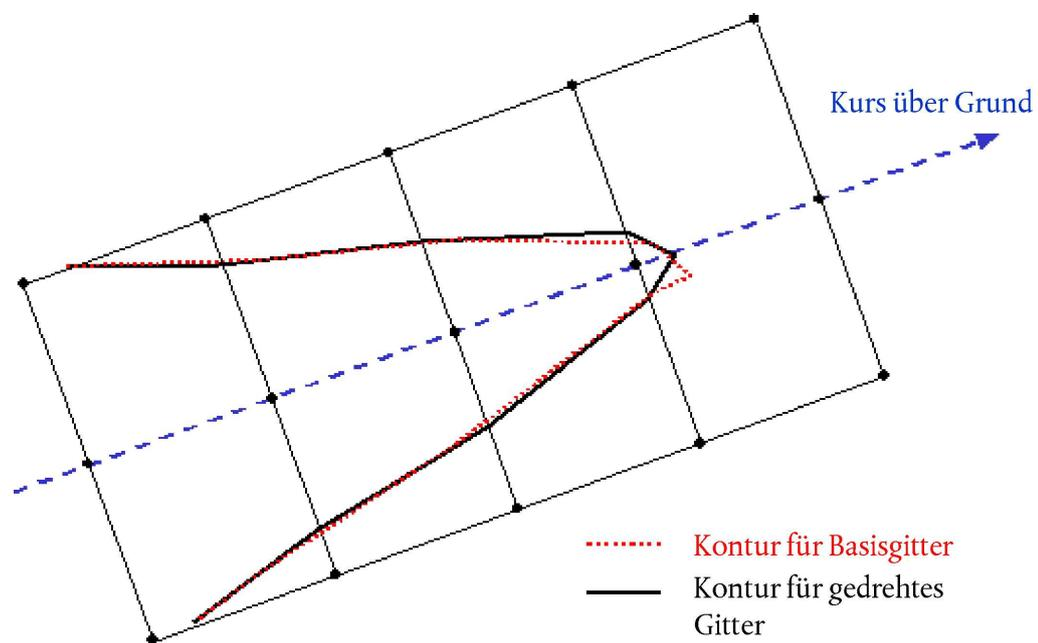
Die einfachste Möglichkeit zur Vermeidung dieses Effekts ist eine engmaschigere Gestaltung des Gitters, was jedoch die Rechenzeit verlängert. Eine elegantere Lösung besteht darin, das Berechnungsgitter so zu drehen, dass seine Richtung parallel zu den Hauptkursen über Grund (d. h. in der Regel parallel zur Hauptpiste) verläuft. **Abbildung 2.7.t** zeigt die Wirkung einer derartigen Gitterdrehung auf den Konturverlauf.
