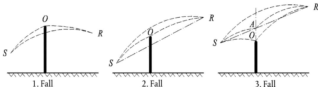
Bei günstigen Bedingungen wird davon ausgegangen, dass die drei gebogenen Schallstrahlen  $SO$ ,  $OR$  und  $SR$  einen identischen Bogenhalbmesser  $\Gamma$  haben, der definiert wird durch:
