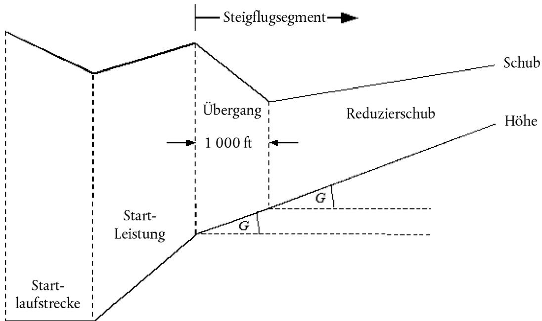
Dem ersten Teilsegment wird eine Strecke über Grund von 1 000 ft (304 m) zugewiesen, und der korrigierte Nettoschub am Ende der 1 000 ft wird auf den Wert der Schubreduzierung gesetzt. (Wenn die ursprüngliche horizontale Entfernung kleiner als 2 000 ft ist, wird eine Hälfte des Segments für die Schubreduzierung verwendet.) Der Endschub am zweiten Teilsegment wird auch auf den Wert der Schubreduzierung gesetzt. Damit wird das zweite Teilsegment mit konstantem Schub geflogen.
