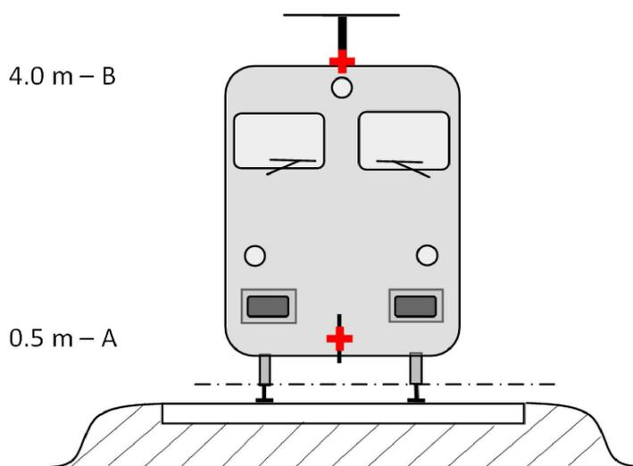
Die verschiedenen äquivalenten Lärmlinienquellen werden in unterschiedlichen Höhen und in der Mitte der Fahrspur platziert. Alle Höhen beziehen sich auf die tangential zu den beiden oberen Oberflächen der beiden Schienen verlaufende Ebene.
