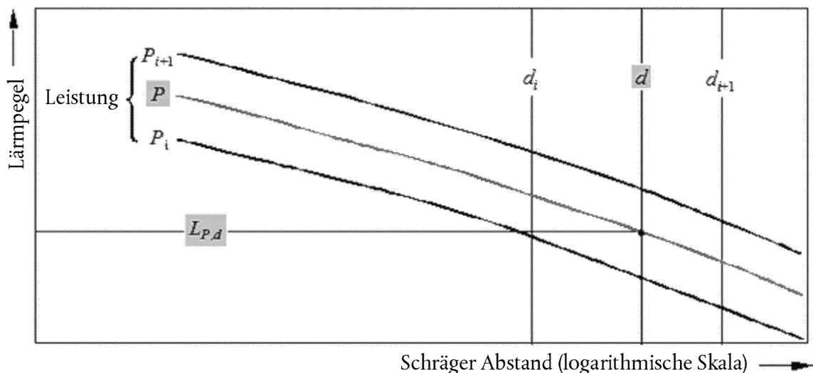
Wenn  $P_i$  und  $P_{i+1}$  Triebwerksleistungswerte sind, für die Lärmpegel zu Abstandsdaten tabellarisiert sind, errechnet sich der Lärmpegel  $L(P)$  in einem bestimmten Abstand für die mittlere Leistung  $P$  zwischen  $P_i$  und  $P_{i+1}$  wie folgt:
