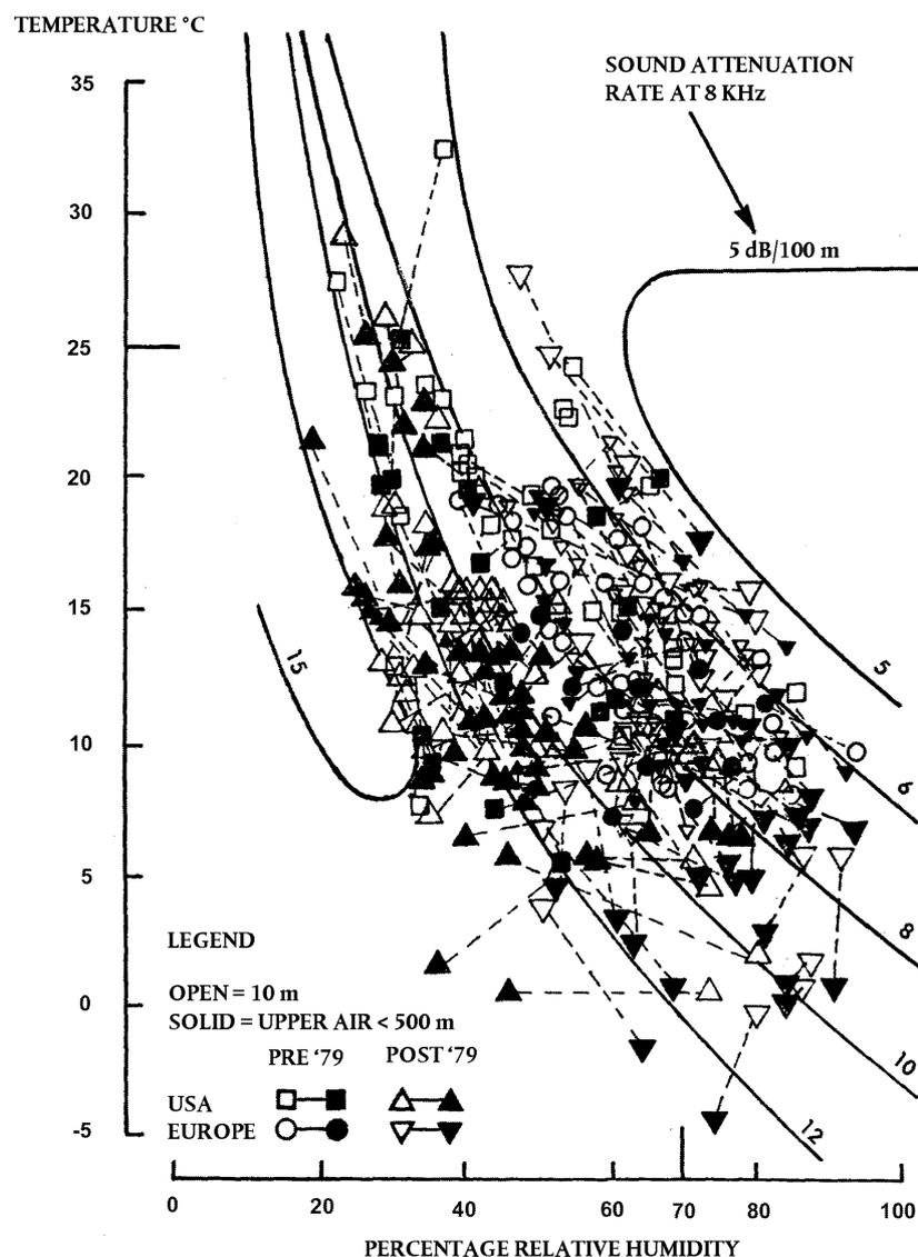
Die Kurven in **Abbildung D-1**, die mit Hilfe eines Industriennormmodells der atmosphärischen Dämpfung ARP 866A berechnet wurden, zeigen über die Prüfbedingungen hinweg mit einer erheblichen Schwankung der hochfrequenten (8 kHz) Schallabsorption zu rechnen wäre (obwohl die Schwankung der Gesamtabsorption vergleichsweise gering wäre).
