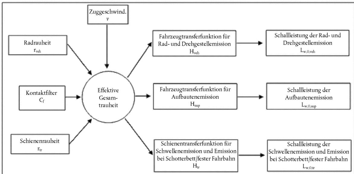
Zum Ausgleich des potenziellen Fehlers infolge der Vereinfachung der Definition der Rollgeräusche, der Definition der Bremsgeräusche und der Definition der stoßartigen Geräusche auf Kreuzungen und Weichen ist zur Ermittlung der effektiven Gesamtrauheit und damit der Schallleistung der Fahrzeuge eine Mindestgeschwindigkeit von 50 km/h (30 km/h nur bei Straßenbahnen und Stadtbahnen) (diese Geschwindigkeit berührt nicht die Berechnung des Fahrzeugstroms) zu verwenden.
