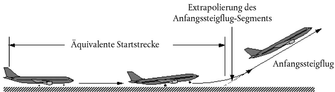
Für eine waagerechte Startbahn wird die äquivalente Startlaufstrecke  $s_{TO8}$  in Fuß anhand der folgenden Gleichung berechnet:
