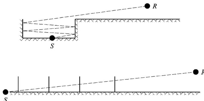
In dieser Darstellung erreicht der Schallstrahl den Empfänger, indem er die Stützwände des Einschnitts „nacheinander durchläuft“, die daher mit Öffnungen verglichen werden können.
