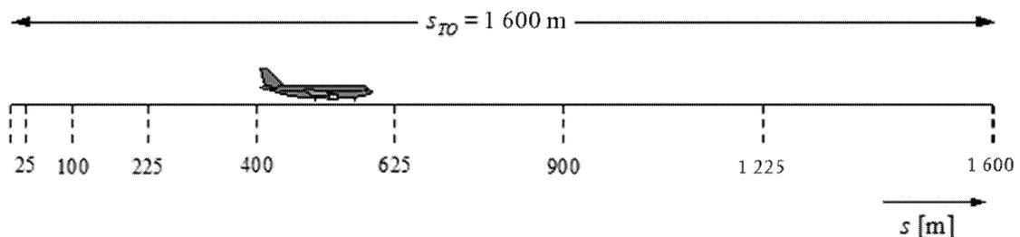
Analog zu den Geschwindigkeitsänderungen errechnen sich die Schubänderungen eines Flugzeugs über jedes Segment mit einem konstanten Inkrement  $\Delta P$  als
