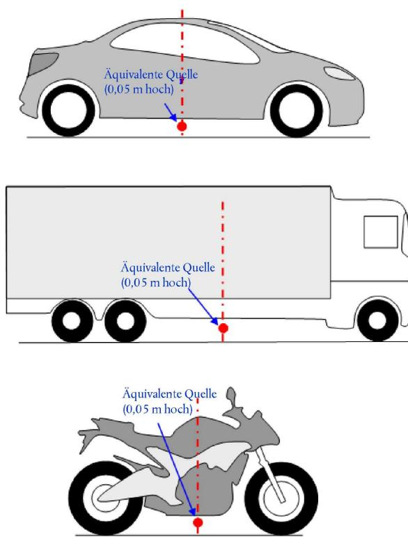
Die Darstellung des Verkehrsflusses erfolgt durch eine Quellenlinie. Bei der Modellierung einer Straße mit mehreren Fahrspuren sollte idealerweise jede Fahrspur durch eine in ihrer Mitte verlaufende Quellenlinie repräsentiert werden. Es ist jedoch auch akzeptabel, bei einer Straße mit zwei Richtungsfahrbahnen eine Quellenlinie in der Straßenmitte oder bei mehrspurigen Straßen eine Quellenlinie je Fahrbahn in der äußeren Fahrspur zu modellieren.
