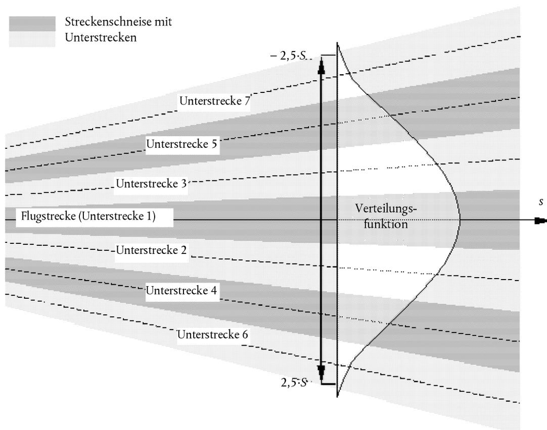
Eine Gaußsche Verteilung lässt sich normalerweise mit sieben einzelnen Unterstrecken hinlänglich modellieren, die sich in gleichmäßigen Abständen in den Grenzbereichen  $\pm 2,5 \times S$  der in **Abbildung C-1** dargestellten „Schneise“ befinden.
