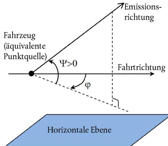
Um der Richtwirkung der Quellen in vertikaler und horizontaler Richtung mittels zusätzlicher Korrekturen Rechnung zu tragen, wird die Stärke der Quelle bei den Berechnungen dann spezifisch als gerichtete Schalleistung je 1 m Länge der Strecke  $L_{W,tot,dir,i}$  ausgedrückt.
