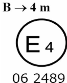
Ein Gurt mit diesem Genehmigungszeichen ist ein Beckengurt („B“) mit einer mehrfach sensitiven („m“) Aufrolleinrichtung des Typs 4, der in den Niederlanden („E 4“) unter der Nummer 062489 genehmigt worden ist; zum Zeitpunkt der Genehmigung enthielt die Regelung bereits die Änderungsserie 06.
