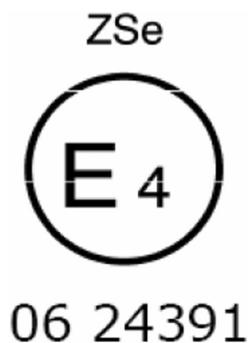
Ein Gurt mit diesem Genehmigungszeichen ist als Teil eines Rückhaltesystems („Z“) ein Spezialgurt („S“) mit Energieaufnahmeeinrichtung („e“). Er wurde in den Niederlanden unter der Nummer 0624391 genehmigt; zum Zeitpunkt der Genehmigung enthielt die Regelung bereits die Änderungsserie 06.
