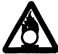
Warnung vor brandfördernden Stoffen
