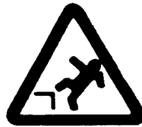
Warnung vor Absturzgefahr
