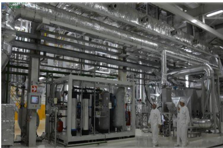
Abbildung 1 — Plasmaschmelzanlage.
