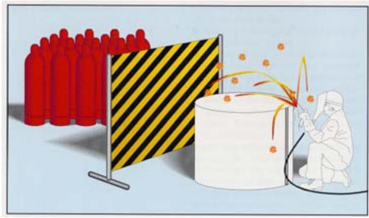
Abb. 4.2: Beispiel für Abschirmmaßnahmen bei Arbeiten mit Funkenflug 4 .
