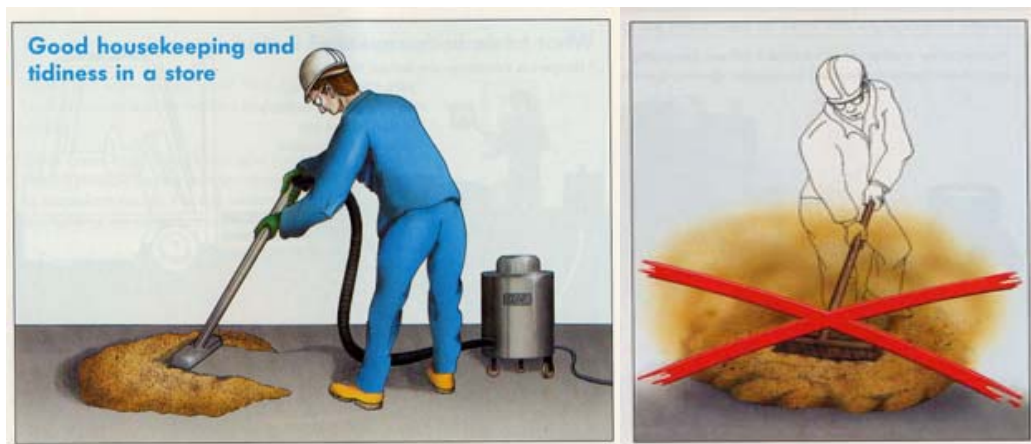
Abb. 3.2: Beseitigung von Staubablagerungen 4 .
