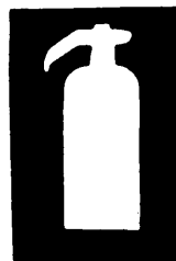
Hinweis auf ein Feuerlöschgerät
