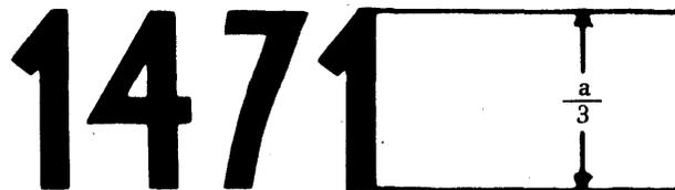
*Legende:* Die Umsturzschildvorrichtung mit dem oben angegebenen EWG-Genehmigungszeichen ist eine Vorrichtung, für die in Deutschland (e 1) unter der Nummer 1471 eine EWG-Bauartgenehmigung erteilt wurde.
