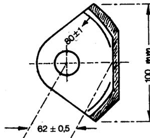
Der Vorsteckbolzen muß einen Durchmesser von 30 mm + 1,5 mm haben und formschlüssig gesichert sein. Die Sicherung muß unverlierbar angeordnet sein.
