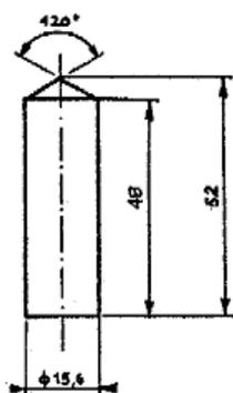
Obr. 2: Válcovitý bronzový píst, rozměry v mm
