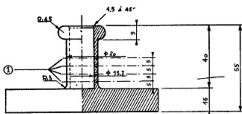
Obr. 3: Dutý bronzový válec, z jedné strany uzavřen, nárys a půdorys rozměry v mm
