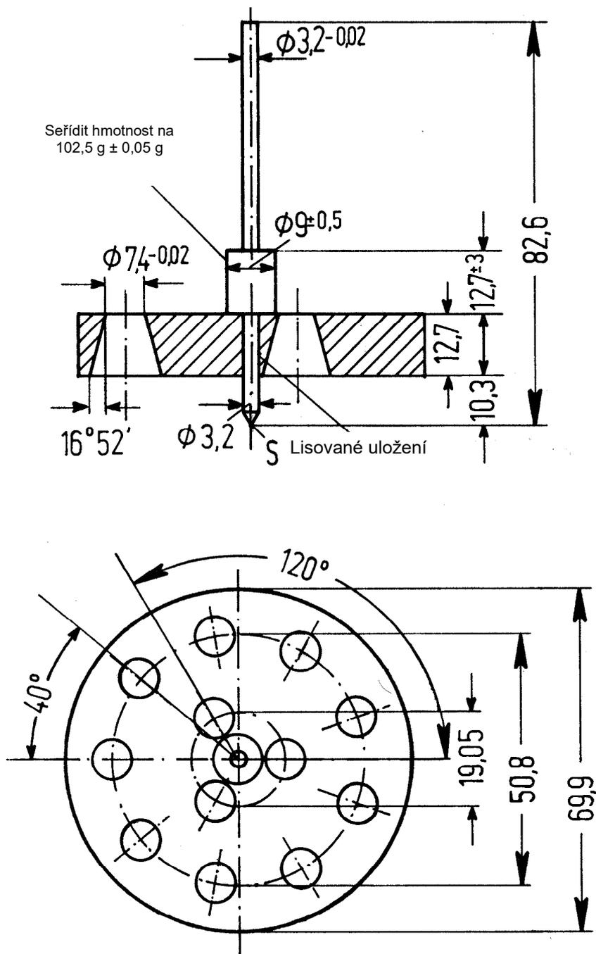
Pro míry bez udání tolerance platí  $\pm 0,1 \text{ mm}$
